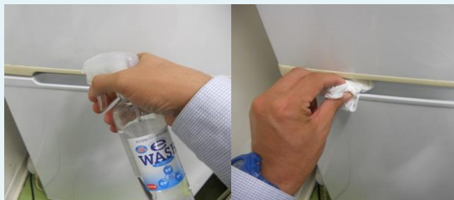
①洗浄(強アルカリイオン水噴霧→ペーパー拭き取り)
